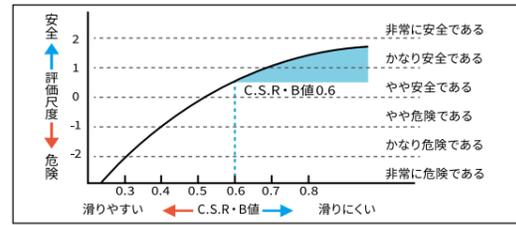
○欧州ではドイツ規格協会が制定するDIN規格による試験方法を用い、履物を履いた状態と素足の状態によるタイルの滑り抵抗を評価しています。
